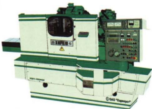
Круглошлифовальный полуавтомат модели **XSH-150Ф20** предназначен для наружного шлифования деталей топливной аппаратуры по замерам окончательно обработанного отверстия в сопрягаемой детали с обеспечением заданного зазора  $0,002...0,005$  мм в каждой паре. Шлифование может быть врезным, продольным или комбинированным.
