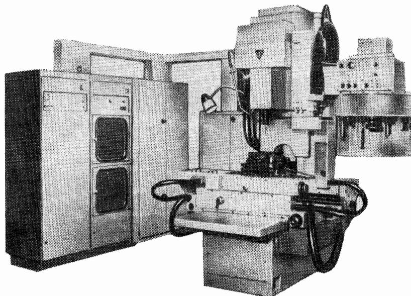
Полуавтомат предназначен для многооперационной обработки деталей из различных материалов в мелкосерийном производстве.
