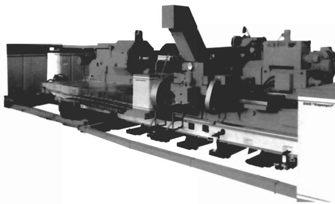
Станки данной модельной группы предназначены как для перешлифовки (ремонта) валков на предприятиях металлургической и других отраслей промышленности, эксплуатирующих валки, так и для изготовления новых валков на машиностроительных заводах. На станках производится шлифование **CVC** поверхностей, выпуклых, вогнутых, цилиндрических а также конических поверхностей.
