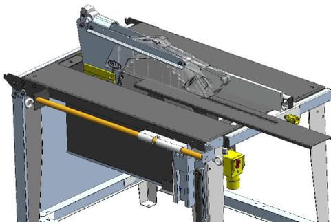
2. При помощи ключа и держателя открутить гайку SW 30 (левая резьба)
