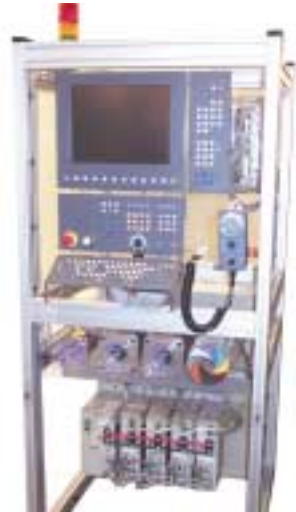
Рис. 2. Комплект электрооборудования, производимого фирмой NCT (Венгрия) для оснащения станков «АСВ»
