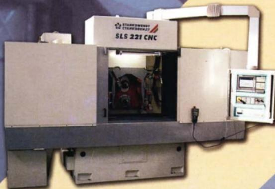
Станок SLS221 CNC предназначен для профильного высокопроизводительного глубинного шлифования элементов турбинных лопаток высокопористыми абразивными кругами и кругами из кубического нитрида бора (CBN).
