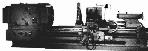
Станки предназначены для токарной обработки труб и деталей трубных соединений, применяемых для добычи и транспортировки нефти и природного газа.
