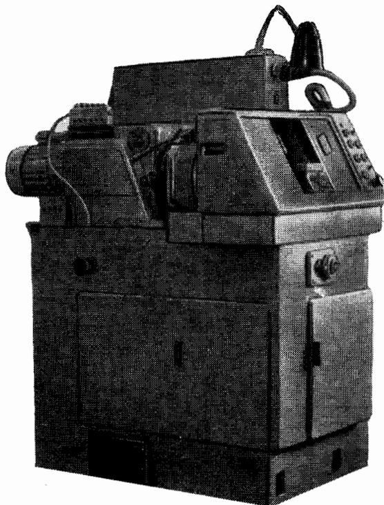
Полуавтомат предназначен для шеввингования закаленных цилиндрических прямозубых и косозубых зубчатых колес методами продольной и диагональной подачи, а также поперечной подачи при применении специального шевера.
